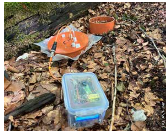
↑ Kammermessung zur Erfassung der Bodenatmung
