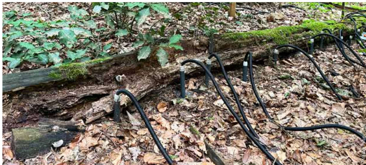
↑ Mittels Saugkerzen werden Bodenwasserproben entlang des Totholzes entnommen.
