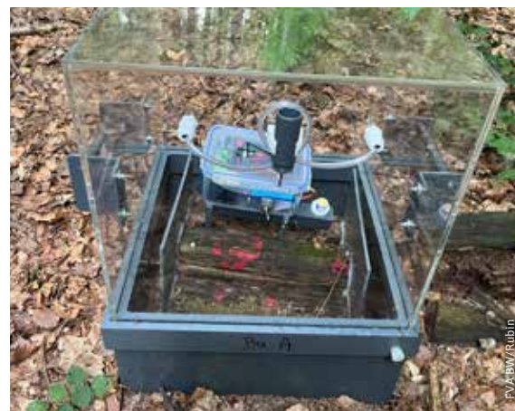
↑ Kammermessung zur Erfassung der CO 2 -Emission aus dem Totholz
