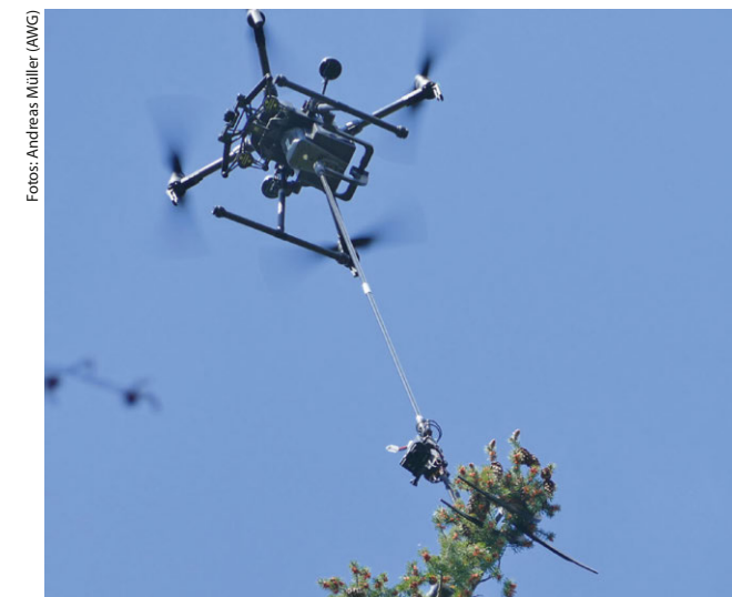
Anfliegen des gewünschten Probeastes und Auslösen der Greif- und Schneidesequenz.
