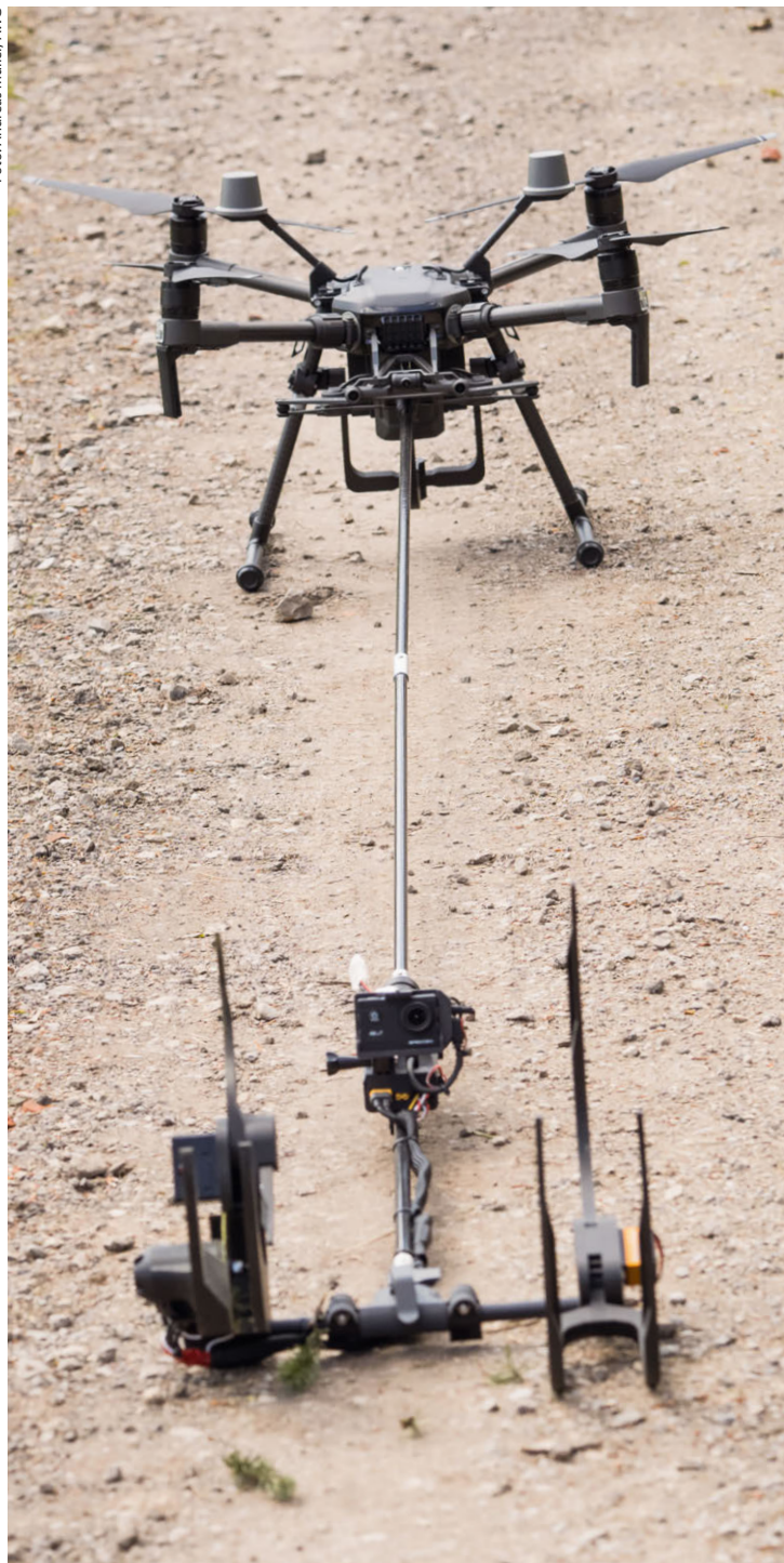
Der Quadrocopter mit montiertem Greifarm und Kamera ermöglicht die einfache Probenahme aus der Baumkrone.
