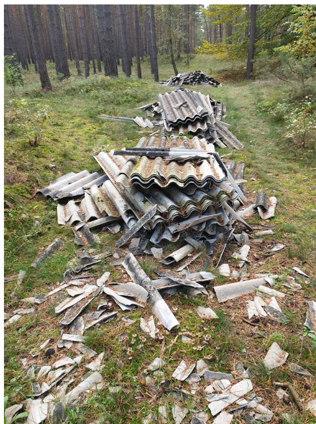
Abb. 2 Gefährlicher Abfall: Asbestplatten (Foto: J. Ecker)
