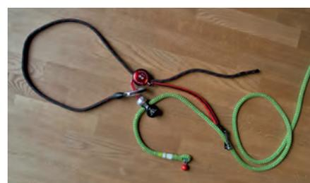
*Une fausse fourche réglable, dispositif d'ancrage permettant d'attacher une poulie à une branche pour installer une corde de rappel.*
