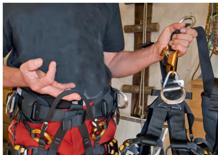
*Sur le modèle de harnais spécial pour arboriste, à gauche, un pont d'attache en corde remplace la boucle de fixation que l'on voit sur le harnais d'industrie.*
