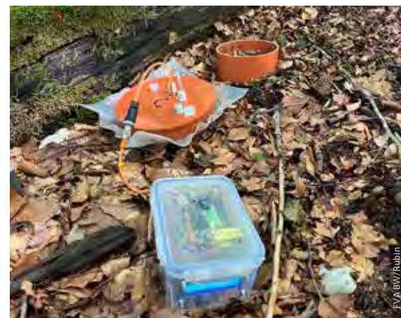
↑ Kammermessung zur Erfassung der Bodenatmung
