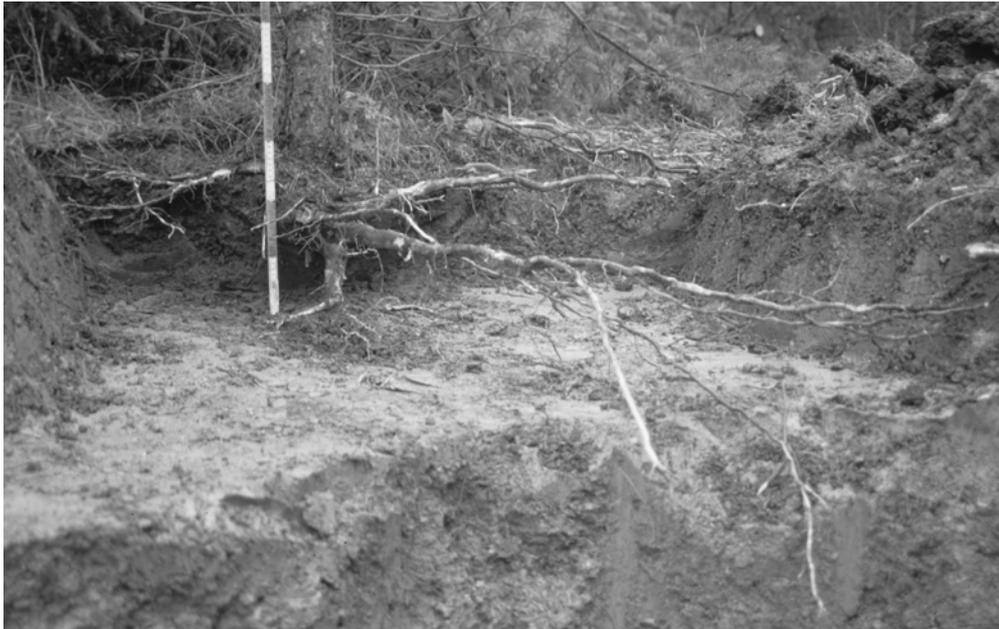
Abb. 1: Die Aufnahme zeigt das Wurzelwerk einer etwa 9jährigen Kiefer (*Pinus sylvestris*). Der Baum wurde auf einer Deponieabdeckung aus einem konventionell eingebauten tonigen Unterboden und einem rd. 30 cm mächtig humosen Oberboden freigelegt. Der Unterboden ist so dicht, dass die Wurzeln in einer für diese Baumart wenig typischen Weise fast nur nach den Seiten und nicht in die Tiefe gewachsen sind. Auf Standorten so geringer Gründigkeit ist vor allem das Risiko von Trockenschäden hoch.
