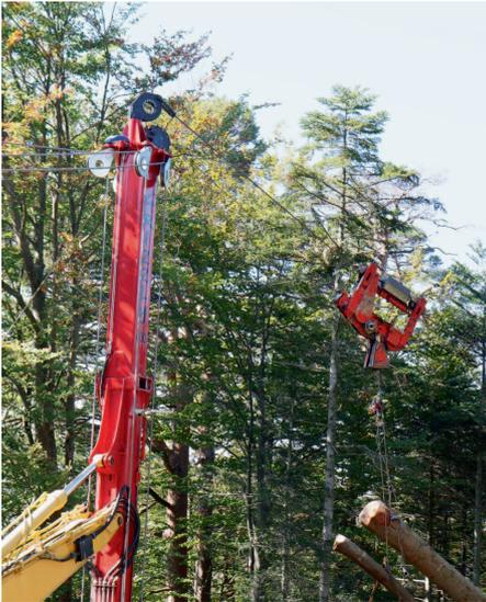
Der Koller 2500-Laufwagen ist funkgesteuert und läuft über Streckenautomatik. Funkchoker erlauben automatisches Lösen der Last.
