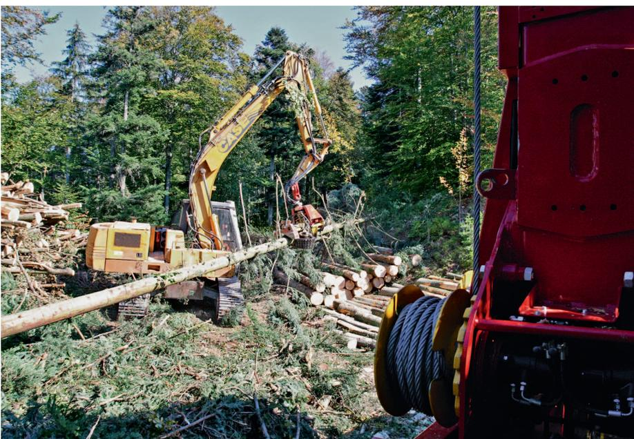
Die vom Yarder gelieferten Ganzbäume sortiert Joël Lema mit einem zweiten Bagger mit Woody 60-Prozessor zu Säge-, Industrie und Energieholzsortimenten aus.
