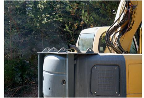
Bei Bedarf kann man dank idealer Baggergeometrie die Abspannseile an den Befestigungsäugen am Heckrahmen verankern.
