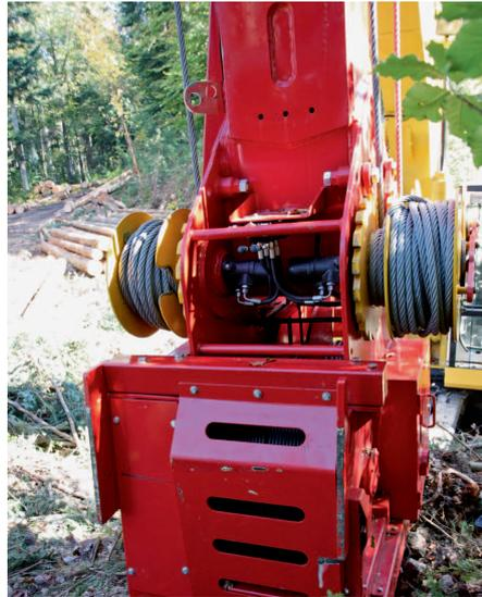
Die vier Winden für die Abspannseile sind oberhalb des Mastsockels montiert, in den die Rollen für Trag- und Zugseil integriert sind.
