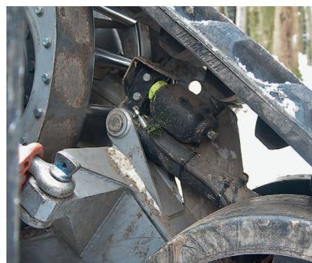
Das Spannsystem der Gummibänder ist hydraulisch. Auf dem Bild sind der Druckspeicher und der Zylinderkopf zu sehen.
