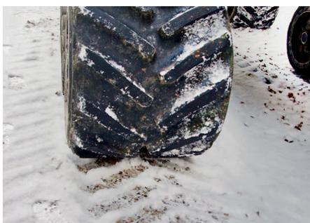
Das Soft Track-Laufwerk hinterlässt kaum Spuren auf dem Boden. Es schont die Waldwege und verursacht, im Gegensatz zu Stahlraupen, auch auf Hartbelägen (Beton, Teer usw.) keine Schäden.
