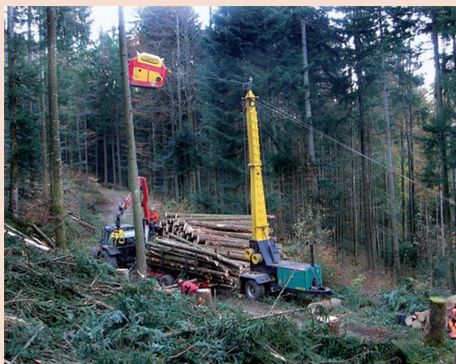
Aufgrund der Vorkonzentration des Holzes durch den Vollernter sind bei der anschliessenden Bringung mit Seilkran höhere Produktivitäten zu erzielen. Rücken des Holzes mit dem selbstfahrenden Laufwagen Woodliner und Zwischentransport mit Traktor und Krananhänger.
