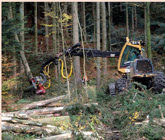
Der Radvollernter CAT 580B mit Pendelarmfahrwerk spielt seine Vorteile im stark coupierten Gelände aus.
