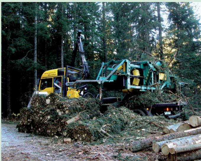
*Der Energieholzbündler löst das Problem der grossen Asthaufen bei der Vollbaumbringung mit Seilkran. Die Bündel lassen sich gut transportieren und lagern.*
