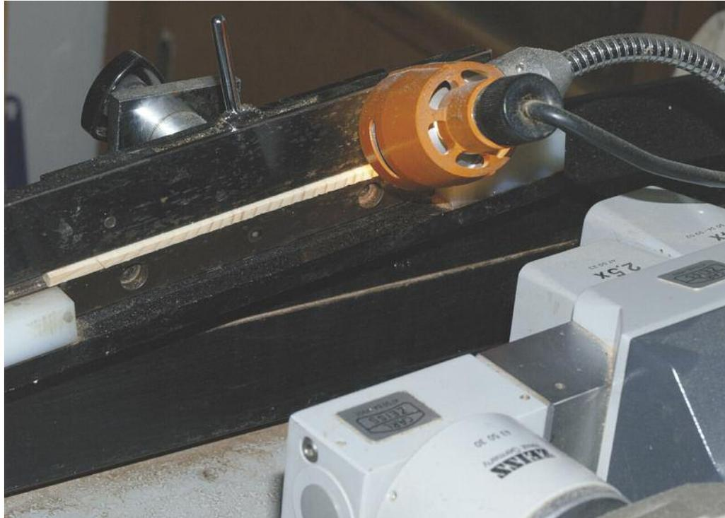
**Der Digitalpositiometer des Instituts für Waldwachstum und Waldbau bei der Messung von Bohrkernen**
