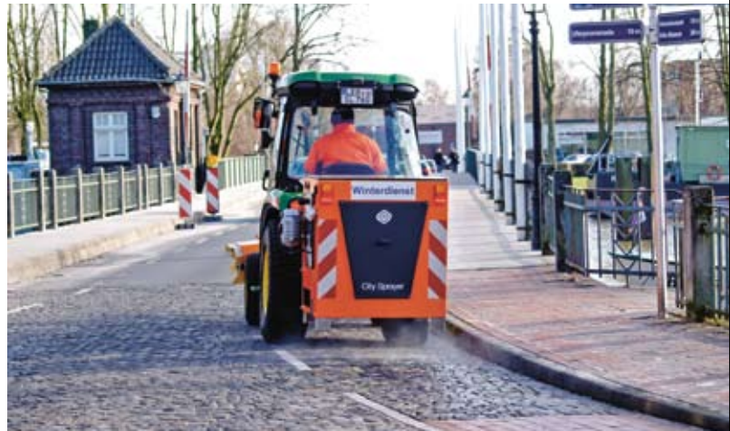
Solestreuer – eine salzsparende Technik. (Bild: EPOKE, City Sprayer)
