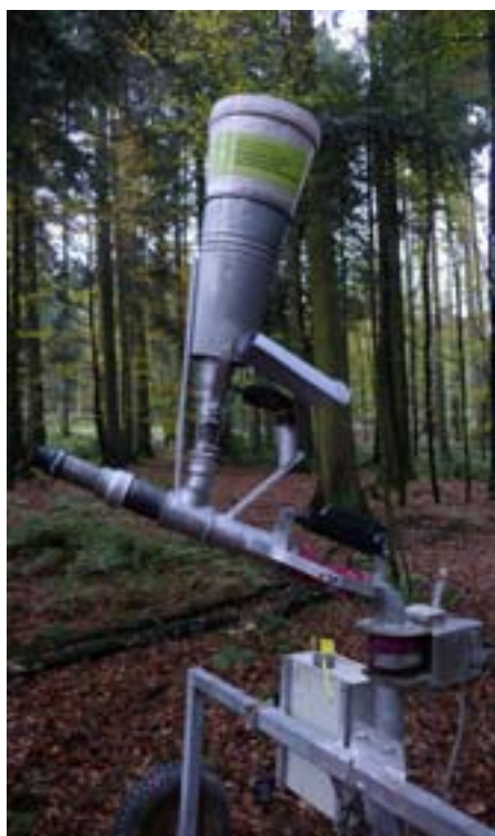
Das «Low-Tech-Verteilgerät»: Es besteht aus einem mit Blechmantel stabilisierten Kunststofftrichter, einer handelsüblichen Akku-Bohrmaschine und einer Metallfassung. Im Inneren der Vorrichtung, im magnetischen Steckensatz, befindet sich eine Art Propeller zur Förderung des Saatgutes.
