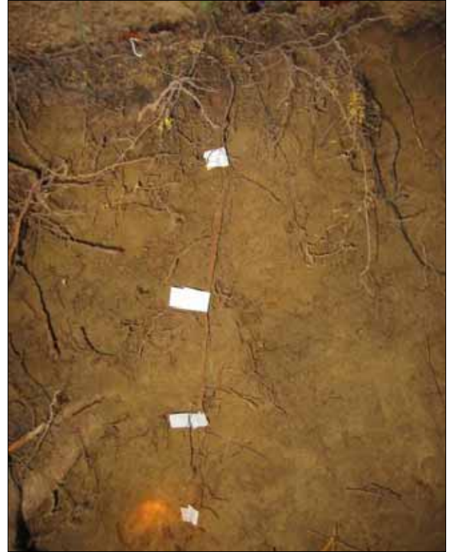
Abb. 5: Tiefenverwurzelung von jungen Buchen vier Jahre nach «Lothar» in verdichtetem Boden (links) und in nicht verdichtetem Boden (rechts). Die Marken an den Wurzeln sind im Abstand von 10 cm angebracht (Sturmfläche Brislach).
