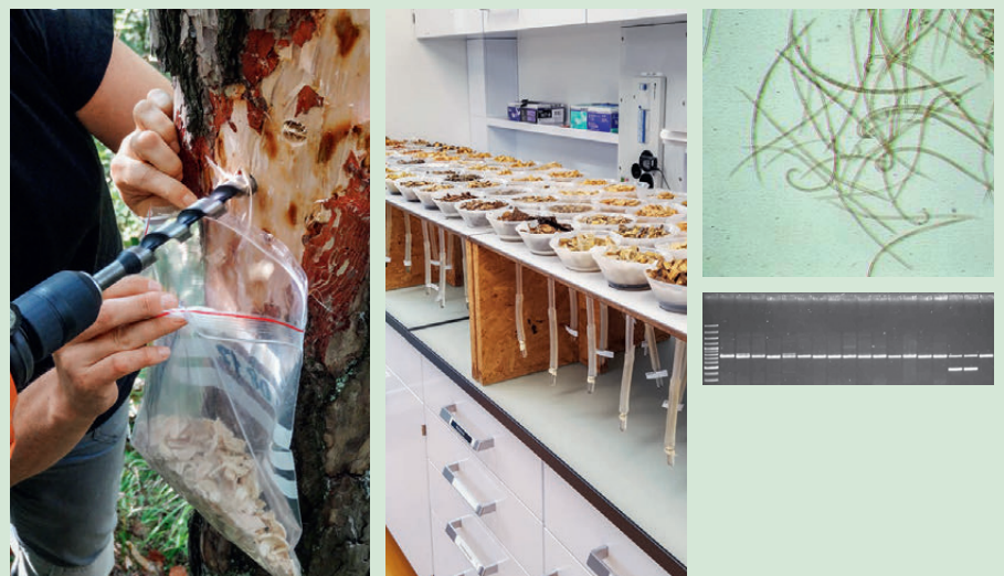
Links: Beprobung einer abgestorbenen Waldföhre ( Pinus sylvestris ); Mitte: Baermann-Trichter mit den entnommenen Holzspänen; rechts: Holz-nematoden unter dem Mikroskop (oben); DNA-Analysenmethode zum Nachweis des Kiefernholz-nematoden (unten): Ein positiver Befund liegt vor, wenn zwei Banden übereinander auftreten. In diesem Fall nur bei den zwei positiven Kontrollproben (Fotos: Phytopathologie, WSL).
