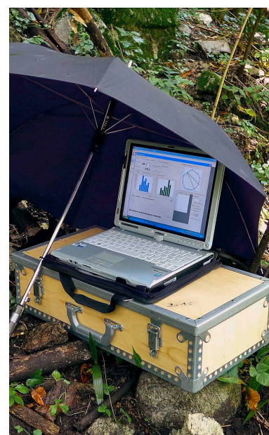
Erfassung von Kernfäulen und internen Rissen mit Tomografen: erste Tests an Götterbäumen mit dem PicUS-Schalltomograf (argus electronic GmbH Rostock) in Claro TI: Links: Schall-Tomogramm mit interner Riss-Darstellung durch CrackDetect – gelbe Striche = Risse, braune Bereiche = festes Holz, violett-blaue Bereiche = geschädigtes Holz. Mitte: PicUS-Schallsensoren an demselben kernfaulen Götterbaum in Claro. Rechts: Tomografie-Messtechnik im Feldeinsatz
