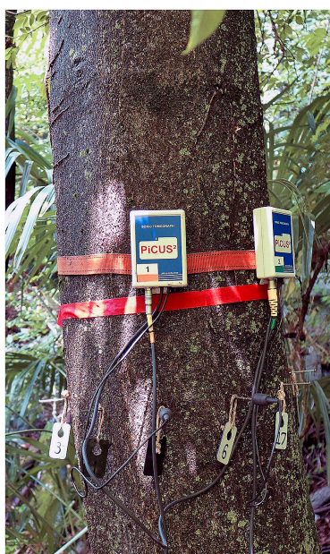
Erfassung von Kernfäulen und internen Rissen mit Tomografen: erste Tests an Götterbäumen mit dem PicUS-Schalltomograf (argus electronic GmbH Rostock) in Claro TI: Links: Schall-Tomogramm mit interner Riss-Darstellung durch CrackDetect – gelbe Striche = Risse, braune Bereiche = festes Holz, violett-blaue Bereiche = geschädigtes Holz. Mitte: PicUS-Schallsensoren an demselben kernfaulen Götterbaum in Claro. Rechts: Tomografie-Messtechnik im Feldeinsatz
