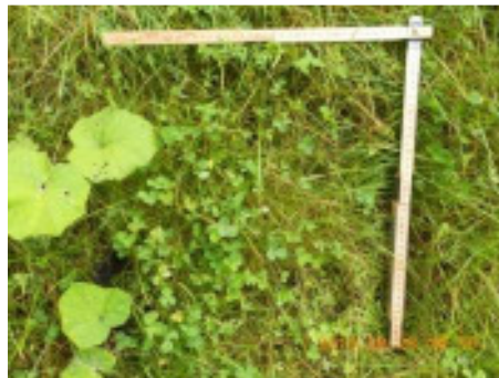
Abbildung 27: Vlies vom Typ 70 Bu 30 Fö 350 gm -2 Trägermaterial PP: Zustand fünf Monate nach Einbau. Links oberes, rechts unteres Ende des Vlieses.
