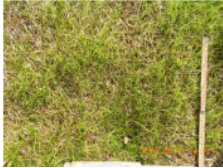
Abbildung 16: Vlies vom Typ 70 Bu 30 Fö 350 gm -2 Trägermaterial PP: Zustand zweieinhalb Monate nach Einbau. Links oberes, rechts unteres Ende des Vlieses.
