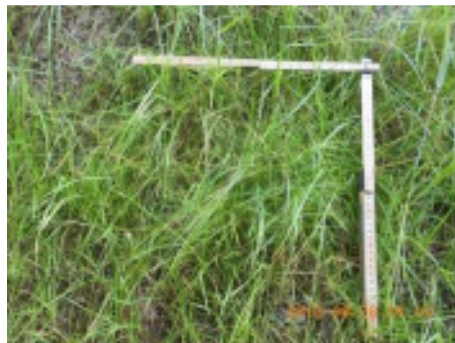
Abbildung 33: Vlies vom Typ 90 Fö 10 Bu 500 gm -2 Trägermaterial PP: Zustand fünf Monate nach Einbau. Links oberes, rechts unteres Ende des Vlieses.
