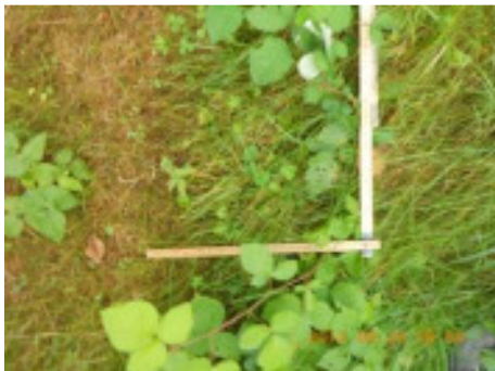
Abbildung 27: Vlies vom Typ 70 Bu 30 Fö 350 gm -2 Trägermaterial PP: Zustand fünf Monate nach Einbau. Links oberes, rechts unteres Ende des Vlieses.
