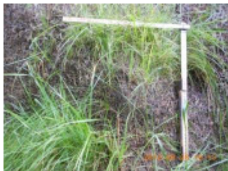
Abbildung 34: Vlies vom Typ 70 Fö 30 Bu 350 gm -2 Trägermaterial PP: Zustand fünf Monate nach Einbau. Links oberes, rechts unteres Ende des Vlieses.
