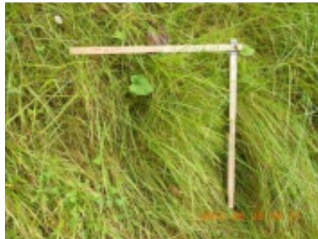
Abbildung 30: Vlies vom Typ 90 Bu 10 Fö 500 gm 2 Trägermaterial PP: Zustand fünf Monate nach Einbau. Links oberes, rechts unteres Ende des Vlieses.
