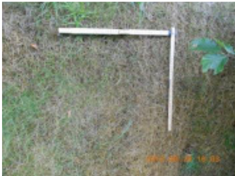
Abbildung 30: Vlies vom Typ 90 Bu 10 Fö 500 gm 2 Trägermaterial PP: Zustand fünf Monate nach Einbau. Links oberes, rechts unteres Ende des Vlieses.
