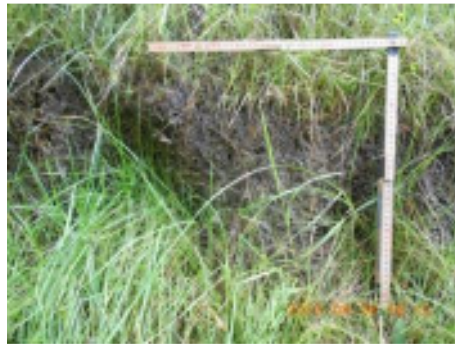
Abbildung 32: Wirtgelege 70 Fö 30 Bu 450 gm -2 Trägermaterial PP: Zustand fünf Monate nach Einbau. Links oberes, rechts unteres Ende des Vlieses.
