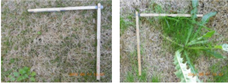
Abbildung 23: Vlies vom Typ 70 Fö 30 Bu 350 gm -2 Trägermaterial PP: Zustand zweieinhalb Monate nach Einbau. Links oberes, rechts unteres Ende des Vlieses.
