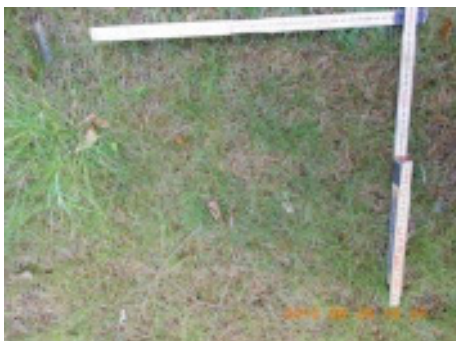
Abbildung 34: Vlies vom Typ 70 Fö 30 Bu 350 gm -2 Trägermaterial PP: Zustand fünf Monate nach Einbau. Links oberes, rechts unteres Ende des Vlieses.
