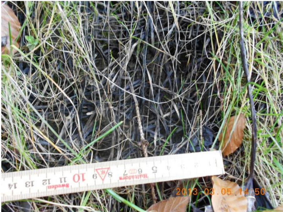
Abbildung 40: Vlies mit hohem Buchenanteil und Jute als Trägermaterial nach elf Monaten und dem ersten Winter (Jahreszahl auf Bild ist falsch).
