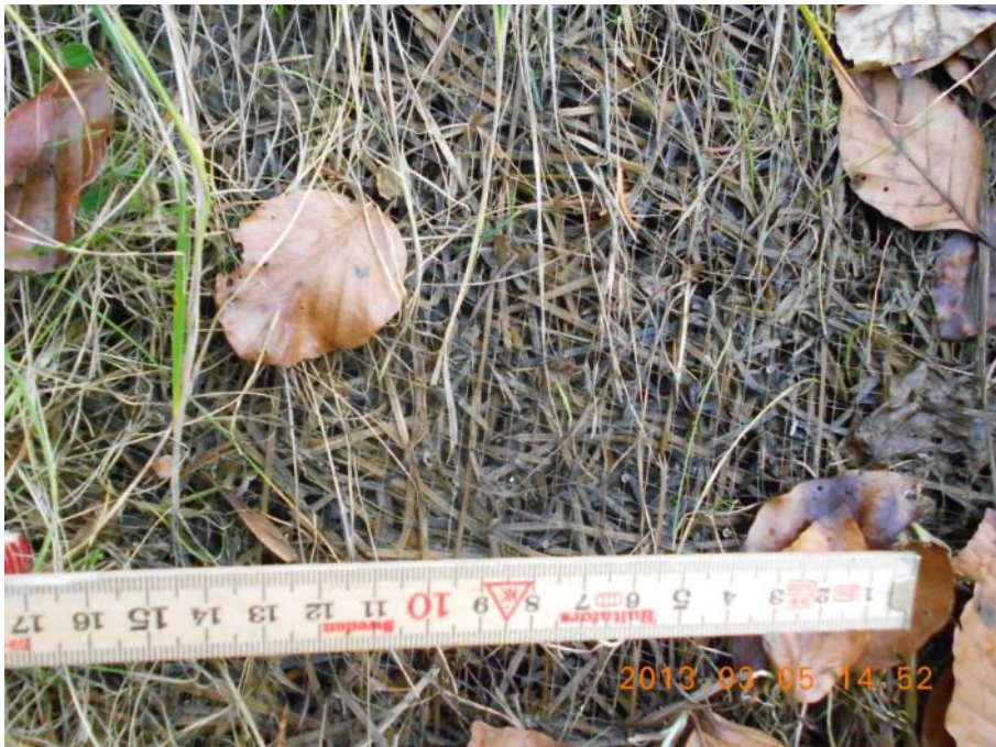
Abbildung 41: Vlies mit hohem Föhrenanteil und PP als Trägermaterial nach elf Monaten und dem ersten Winter (Jahreszahl auf Bild ist falsch).
