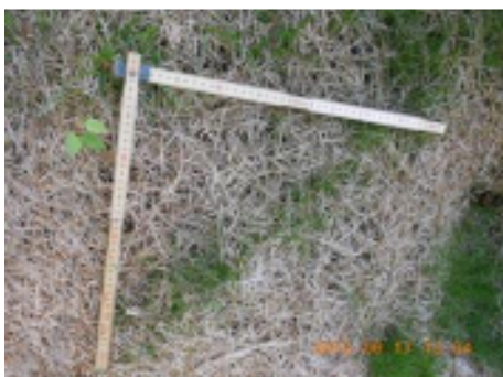
Abbildung 19: Vlies vom Typ 90 Bu 10 Fö 500 gm -2 Trägermaterial PP: Zustand zweieinhalb Monate nach Einbau. Links oberes, rechts unteres Ende des Vlieses.
