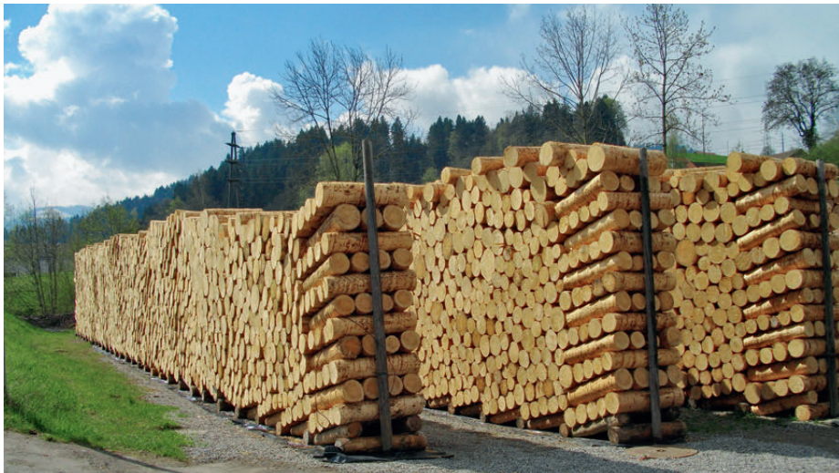
Vortrocknen des Holzwolle-Rohholzes auf dem Rundholzlagerplatz der Lindner Produktions AG.
