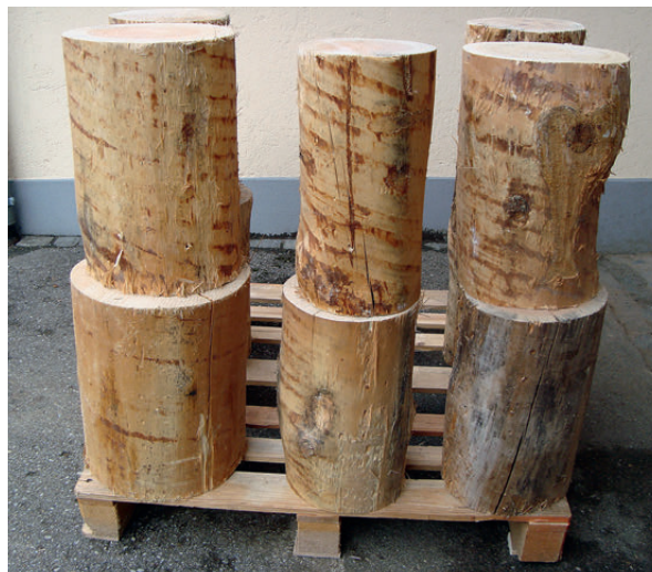
Holzwolle-Rohholz, von links nach rechts: A-Qualität: hell, geradewüchsig, kaum Äste; B-Qualität: hell, leicht drehwüchsig, wenig Äste; C-Qualität: nicht verfärbt, drehwüchsig, astig. Das verfärbte Beispiel rechts unten ist nicht zur Produktion von Holzwolle geeignet.
