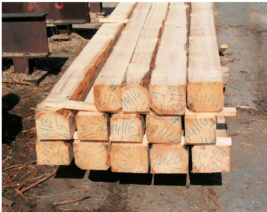
Abbildung 2: Einstielig geschnittene Balken aus «Mondholz» mit Schäden durch falsche und zu lange Lagerung. Der Kunde verliess sich darauf, dass «Mondholz» nicht fault bzw. nicht wurmt.
