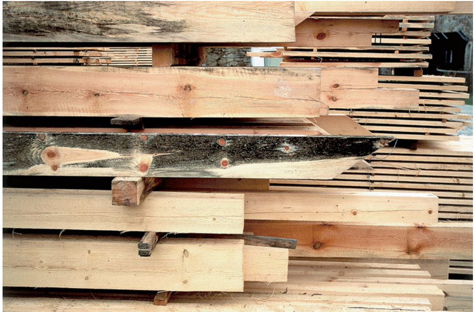
Abbildung 1: Reklamiertes Mondphasenholz für einen Dachstuhl: Rundholzeinschlag Anfang Februar 2000, 225 fm Fichte und Kiefer. Rundholzeinschnitt in einem Sägewerk der Region während der Sommer- und Herbstmonate. Gesamtschaden durch Pilz- und Insektenbefall am Rund- und Schnittholz ca. EUR 15 000.– (Foto: J. Triebel).
