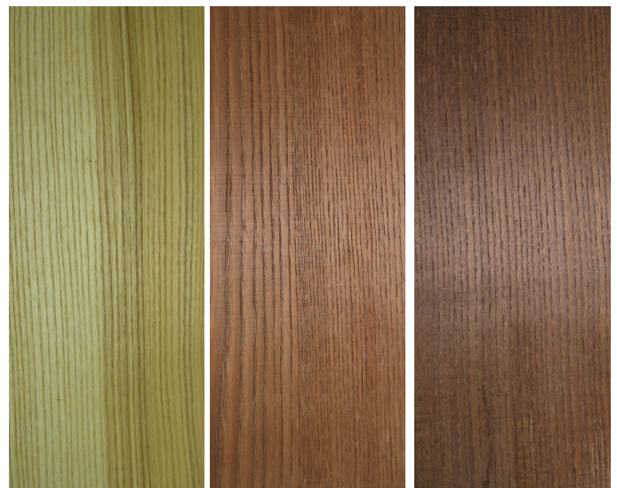
Abbildung 5: Esche mit Braunkern. Links unbehandelt, Mitte Stufe 2, rechts Stufe 3.
