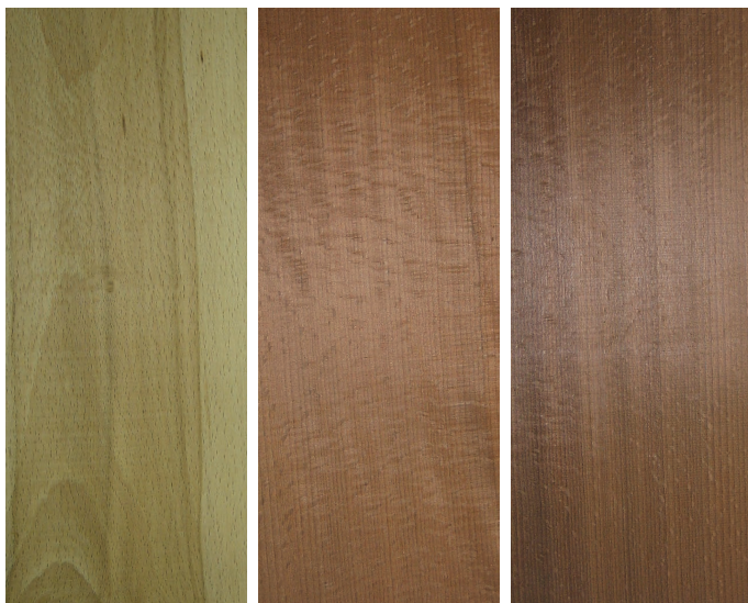
Abbildung 4: Buche mit Rotkern. Links unbehandelt, Mitte Stufe 2, rechts Stufe 3.
