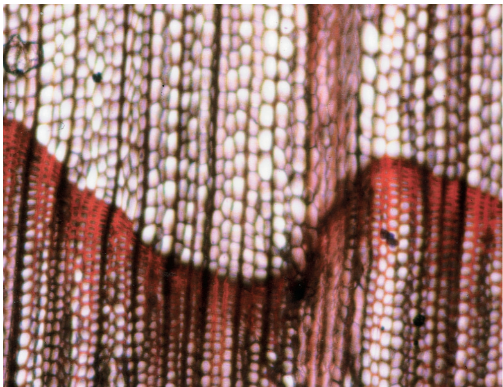
Mikroskopischer Querschnitt. Bei Vegetationsbeginn entstehen weitleumige, dünnwandige Frühholzfasern, später wird die Wandung der Fasern immer mehr verdickt und das Lumen der Röhrrchen verengt. Der Übergang von den letzten Spätholzzellen zu den nächsten Frühholztracheiden bildet die Jahrringgrenze. In der stark gestörten Zone sind zwei Markstrahlen anzutreffen, die die andern in der Breite stark übertreffen. In den haselwüchsigen Bogen ist eine vermehrte Speicherzellenproduktion vorhanden. Die Anzahl Markstrahlen pro mm laufende Jahrringgrenze ist im gestörten Bereich zirka \frac{1}{4} grösser.
