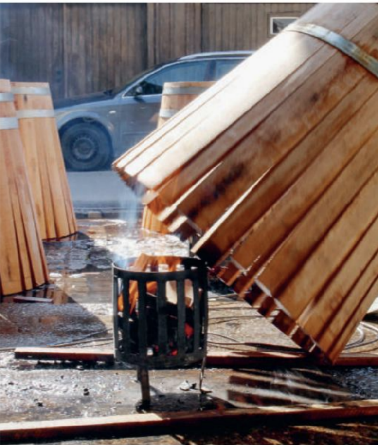
Mit dem Feuer wird das Holz biegsam gemacht.
