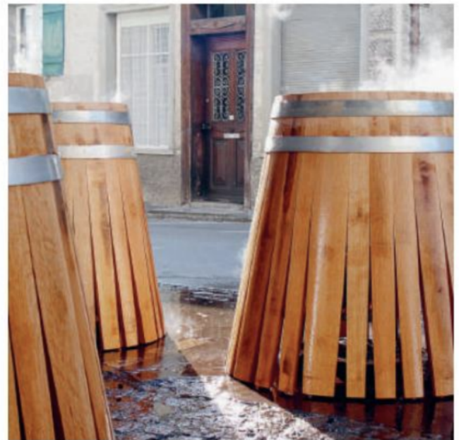
Unter Zugabe von Wasser beginnen die Fässer zu dampfen.
