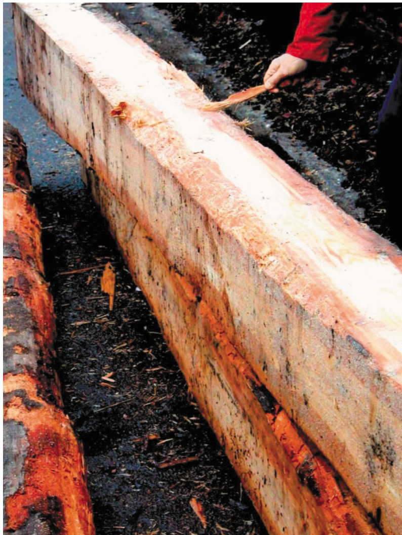
Abb. 4: Die Qualität der Schnittware wird durch Mantelfäule beeinträchtigt.
