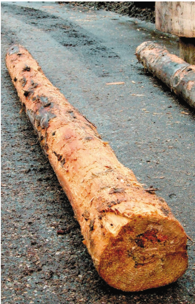
Abb. 3: Splintholzverlust nach dem Entrindungsprozess.
