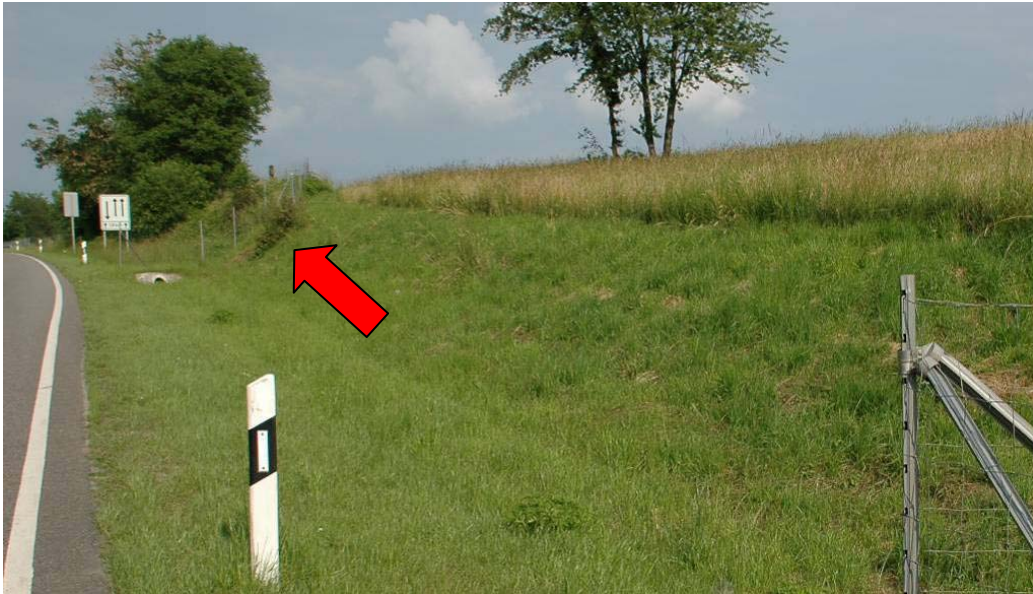
Abb. 4-12: Sensorüberwachter Bereich Anlage 1 Aglasterhausen, Feldseite (2007). Ein bis auf den Stumpf zurück geschnittener Ahorn schlägt erneut aus und beeinträchtigt die Sensorüberwachung. Oberhalb der Böschungskante wäre eine Mahd der Wiese um weitere 2-3m sinnvoll, denn bei Wind oder Regen neigt sich das Gras in Richtung der Böschung und beeinträchtigt die Erfassung von Wildtieren durch die Sensoren. Die Wildunfallserie (vgl. Kap. 4.3) ereignete sich am Zaunende Fahrtrichtung Mosbach (also etwa auf Höhe des Roten Pfeils).
