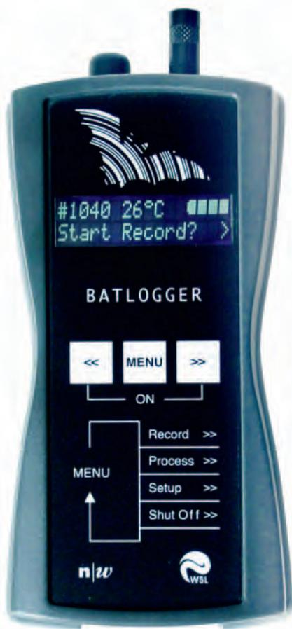
Mit einer Länge von rund 16 Zentimetern ist der Batlogger im Vergleich zu älteren Forschungsgeräten sehr handlich. Zudem kann er auch ohne ständige Bedienung über einen längeren Zeitraum am gleichen Ort im Einsatz stehen.
