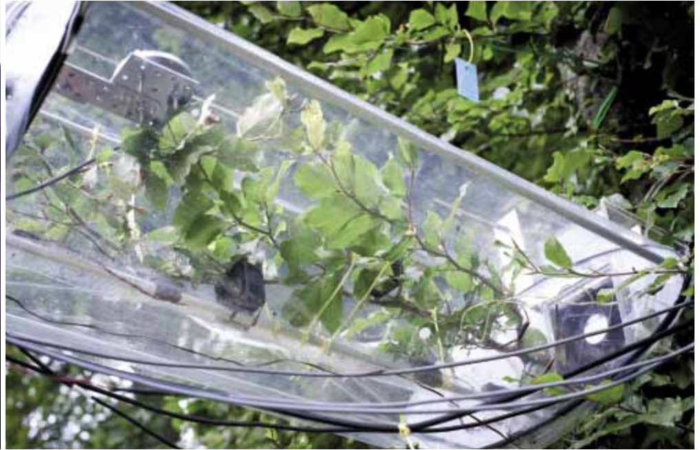
Die Luft in den transparenten Astkammern wird nach jedem Messzyklus über Schläuche zu den Laserspektrometern in der Hütte transportiert.
