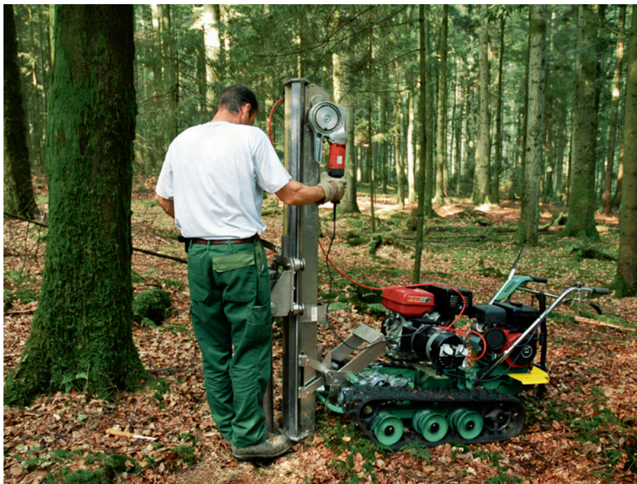
Beprobung der Feinwurzeln mit einem Humax-Bohrgerät (oben).
