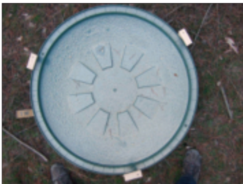
Abb. 2.4: Auffangschale \varnothing = 0,99\text{ m} ; A = 0,77\text{ m}^2
