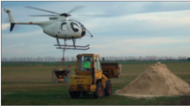
(a) Aufnahme des befüllten Kübels durch den Hubschrauber
