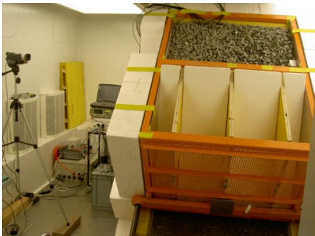
Abb. 2: Auslösung einer Hangrutschung über einem künstlichen Permafrostkörper unter kontrollierten Bedingungen im Kältelabor (Photo: A. Rist)
