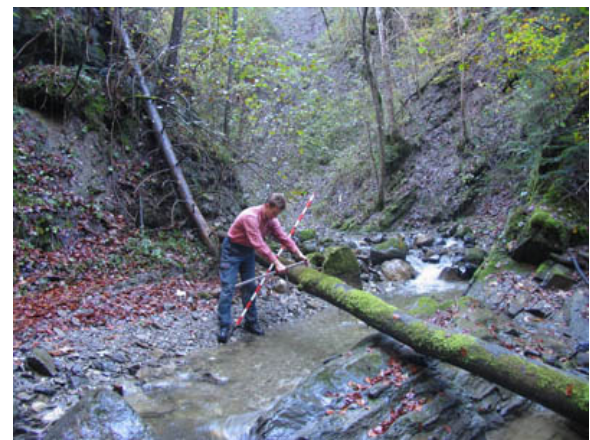
Abb.2: Zu jedem Holzstück im Bachbett mit einem Durchmesser \geq 10 cm und einer Länge \geq 1.0 m wurden verschiedene Parameter (Abmessungen, Holzzustand, Herkunft, usw.) erfasst (Foto: H Bucher).
