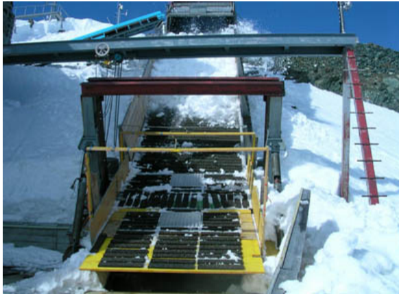
Abb. 1: Schneegleitbahn des SLF auf dem Weissfluhjoch. Die Rückhalteklappe hat sich geöffnet und rund 25m 3 Schnee stürzen hinunter. Im unteren Teil sind die 2 Kraftmessplatten sichtbar, mit denen die Normal- und Schubkräfte gemessen werden (Foto: SLF).
