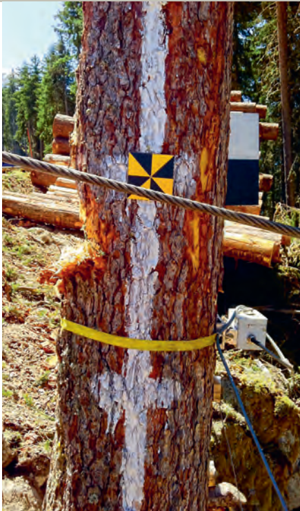
Abb. 4: Kerbe im Stamm nach dem zweiten Einschlag (Bild: Axel Volkwein)
