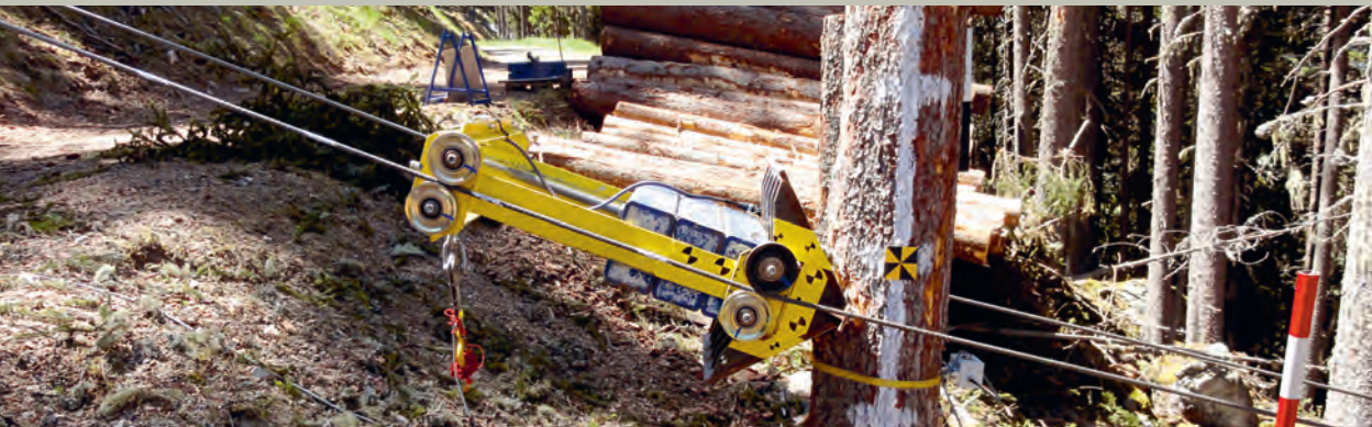
Abb. 1: Anprall des Metallschlittens in den Testbaum (Bild: Axel Volkwein)
