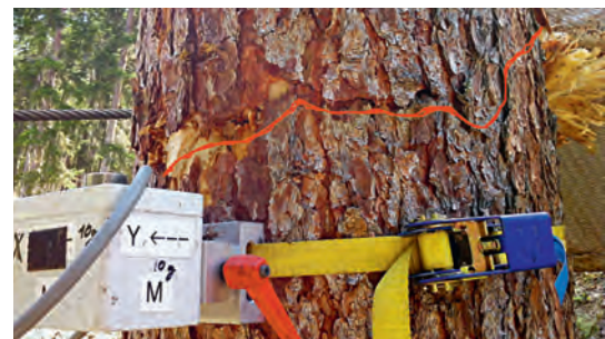
Abb. 5: Scherbruch (rot) durch den Stamm an der Einschlagstelle. (Bild: Axel Volkwein)
