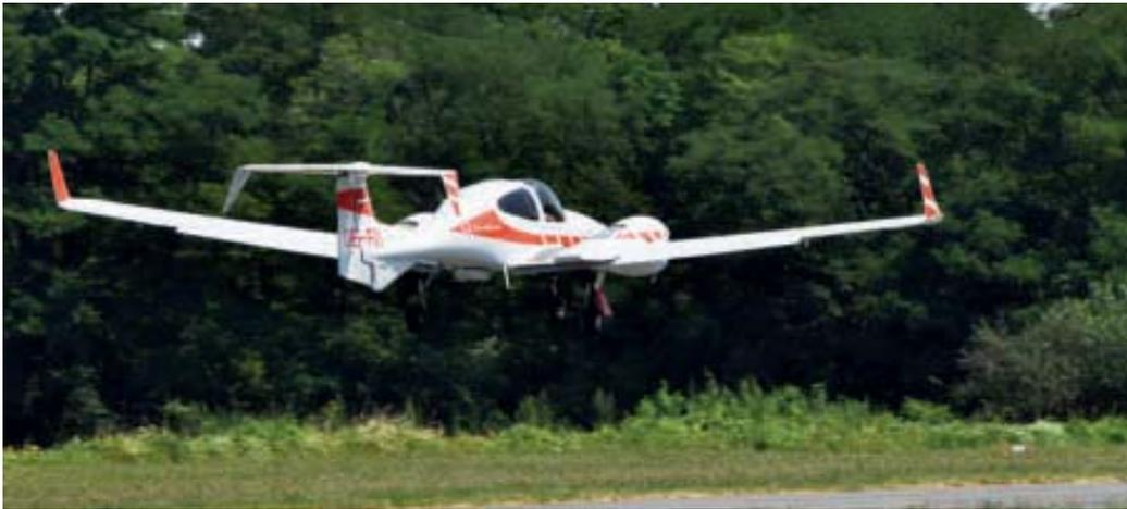
Mit Airborne Laser Scanning (ALS) lassen sich Wälder im Nu digital kartieren. Hier hebt ein Spezialflugzeug der Firma Riegl mit in der Nase eingebauter Vermessungsausrüstung ab.
