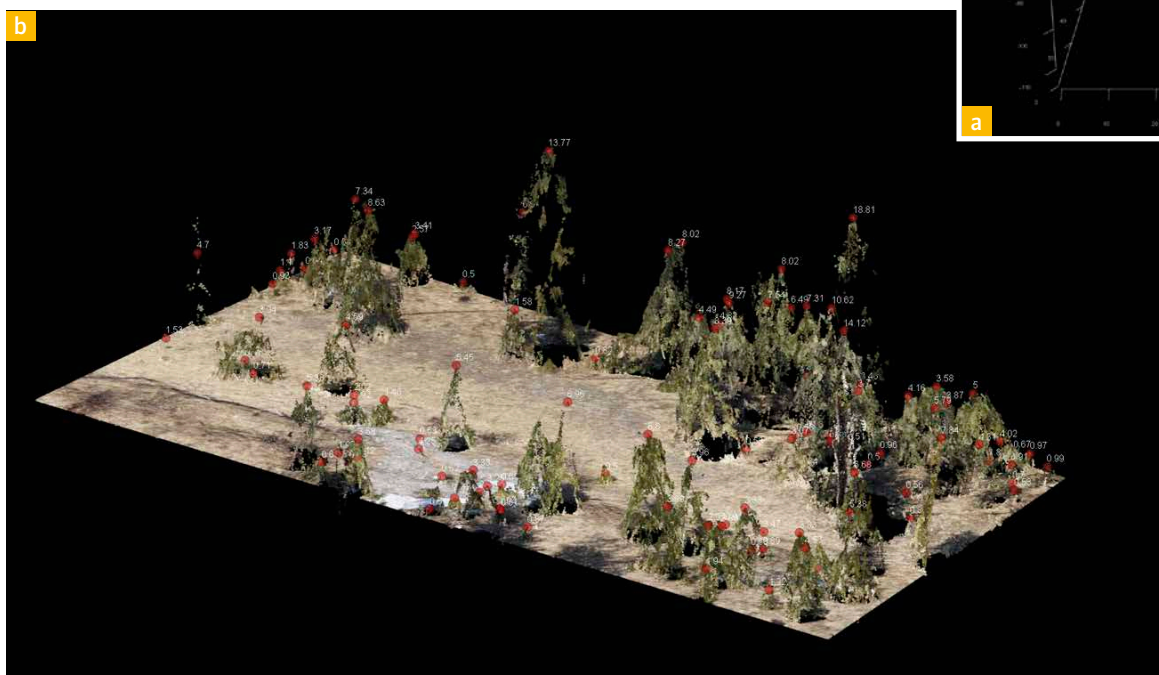
1 Automatisierte Einzelbaumdetektion und Höhenbestimmung eines lichten Fichtenbestands in einem weiten Höhenbereich zwischen 0,5 und 19 m auf der Grundlage überlappender Drohnen-Luftbilder (digitale Photogrammetrie) a: reales Relief; b: normalisiert auf Bodenniveau
