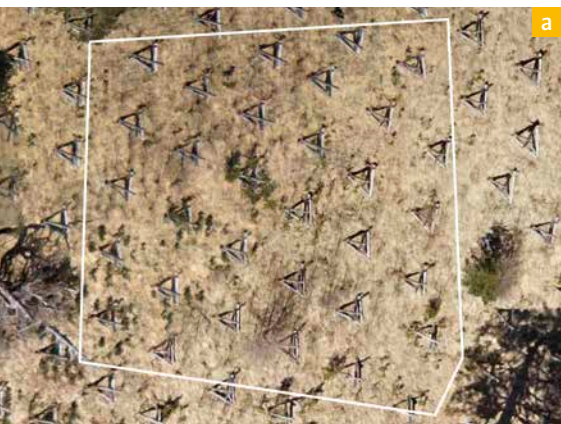
2 a: UAV-Luftbild eines stark vergrasteten Sanierungsbereichs mit Dreibeinböcken und Nadelbaum-Pflanztrupps (Befliegung mit Senkrechtstarterdrohne, Bodenaufösung knapp 3 cm) b: Automatisierte Einzelbaumdetektion (rote Kugeln) und Höhenverteilung der wintergrünen Sanierungspflanzen
