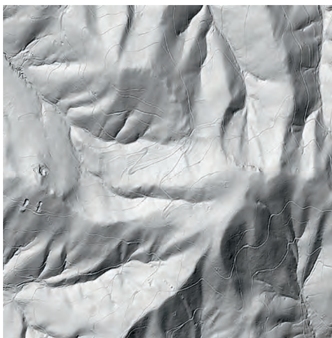
Abbildung 9: Darstellung eines DGM als Reliefschattierung (links) und als Hangneigung (rechts) [Geobasisdaten © LGL, www.lgl-bw.de].
