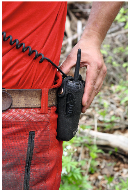
Das Funkgerät trägt man am Gurt, und das Kabel wird gut unter der Kleidung verschlauft, damit es sich nirgends verfängt.
