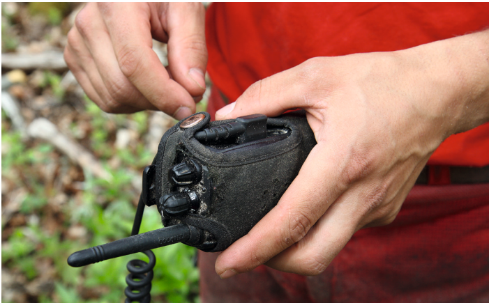
Wenn man das Headset-Kabel clever verschlauft, ergibt sich weniger Belastung auf die Stecker. Die Etuis haben sich als sehr robust erwiesen.
