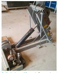
Seilwindenprüfstand: Es werden die Zugkraft, die Bremshaltekraft sowie die Überschneidung von Kupplung und Bremse gemessen.
