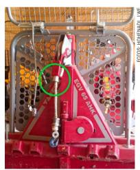
Abschalteinrichtung: Der Stopper schaltet den Seileinzug so früh ab, dass die Finger nicht eingequetscht werden können.
