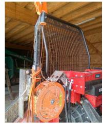
Hilfsseilwinde: Mittels leichtem Kunststoffseil kann das Seilwindenseil ohne Kraftaufwand zur Last gezogen werden.
