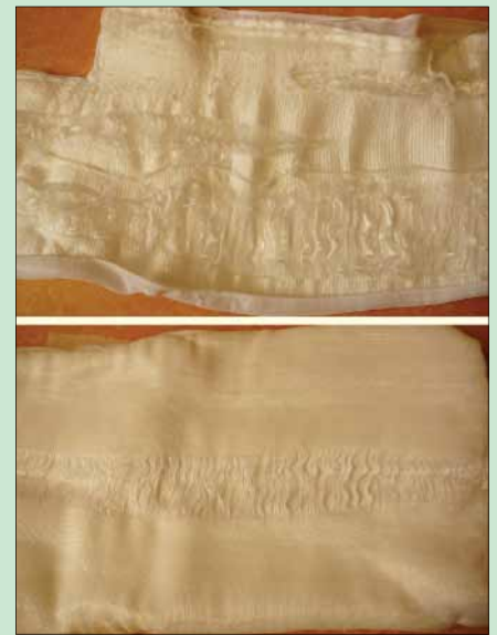
Abb. 1: Einlage aus Hermes-Material (oben) und Engtex-Material (unten) nach 15 Wäschen
