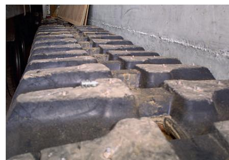
Mit Schraubspikes ausgerüstete Gummiraupen
