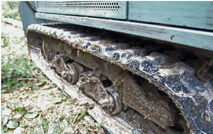
Gummiraupenfahrwerk mit vier Pendelstützrollen
