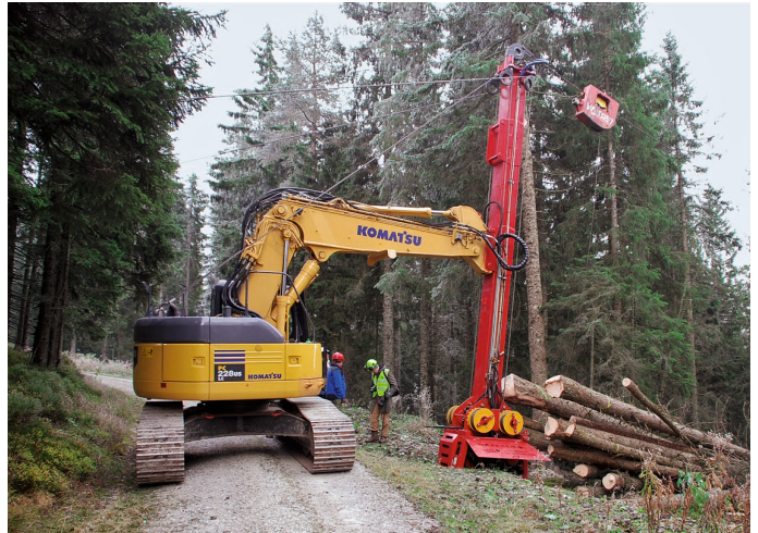
Das Bagger-Kippmastgerät der Firma Herzog Forsttechnik ist einfach und schnell einsetzbar. Es eignet sich gut für die Bringung von ganzen Bäumen und für kleine Seillinienabstände.
