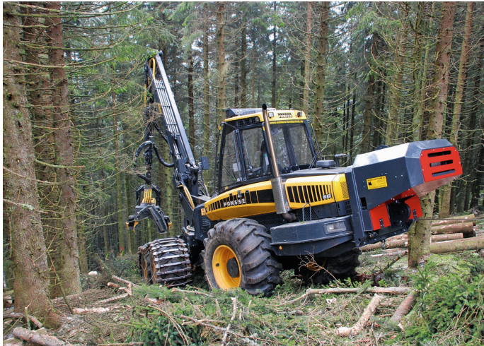
Vollmechanisierte Holzernte im Steilhang: Ponsse-Radharvester mit angebauter Traktionsseilwinde der Firma Herzog Forsttechnik.
