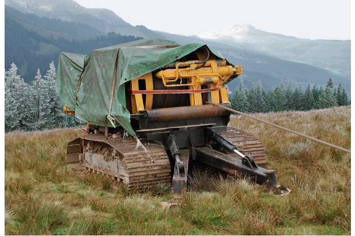
Die auf einem Raupenfahrwerk aufgebaute Tragseilwinde von Herzog Forsttechnik wiegt 18 t und kann als Berg- oder Talanker verwendet werden.
