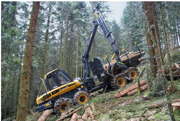
Mit der Traktionswinde kann der Forwarder auch in steilem Gelände noch sicher arbeiten.
