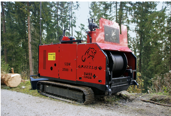
Diese Winde für Langstreckenseilkrane stand als weiterer Prototyp der Firma Herzog Forsttechnik im Einsatz. Speziell daran sind der Aufbau auf einem verstellbaren Raupenfahrwerk und der oben liegende Seileinzug.
