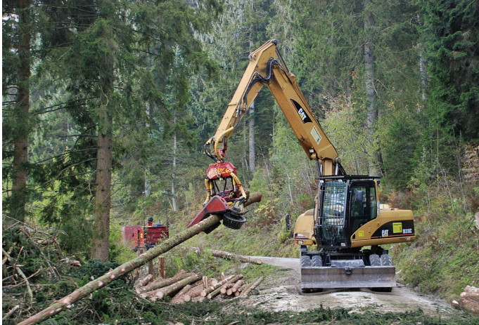
Rationelles Aufarbeiten der Bäume mit dem Prozessor auf der Waldstrasse. Beim Einsatz von Funkchokern muss der Maschinist die Bäume nicht mehr von Hand abhängen.
