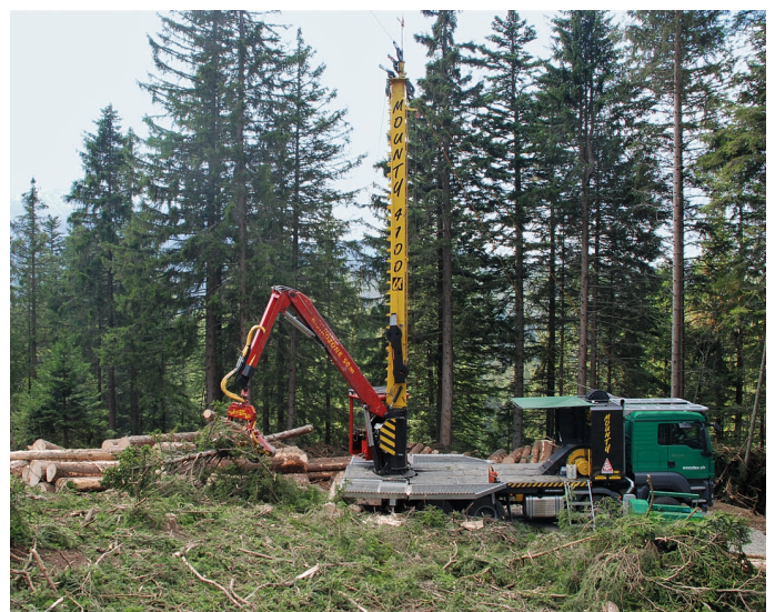
Das Kombiseilgerät Mounty 4100 U steht hier bei Ganzbaumbringung talseitig im Einsatz.
