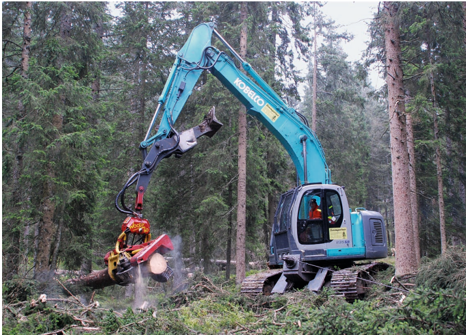
Der Raupenharvester kann mit der eingebauten Seilwinde die Bäume ausserhalb des Kranbereiches zuziehen. Dadurch sind bei der Holzbringung mit dem Seilkran sehr weite Linienabstände möglich.
