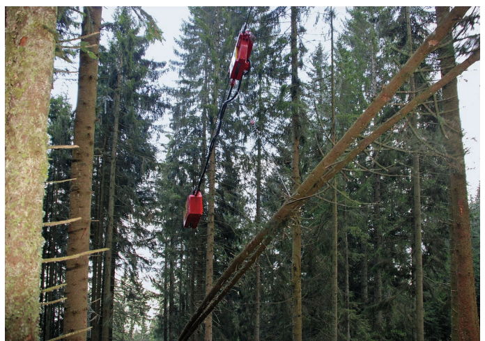
Mit diesem neu ent- wickelten Doppel- laufwagen der Firma Herzog Forst- technik werden ganze Bäume freihängend zu Tal gebracht.
