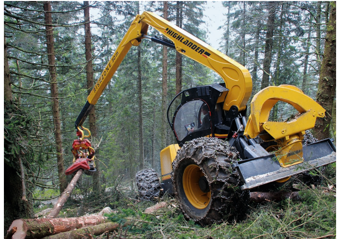
Der Hangharvester Highlander der österreichischen Firma Konrad Forsttechnik ist sehr geländegängig und mit einer Seilwinde und einer Klemmbank ausgerüstet.
