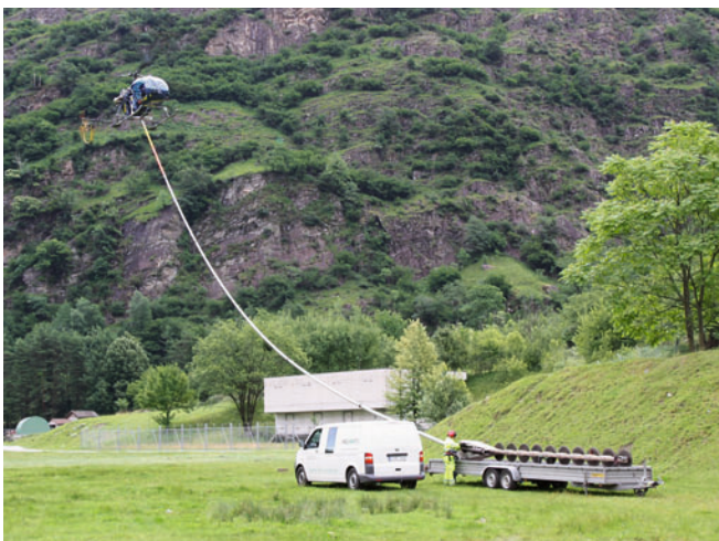
Die 8 m lange Säge hängt an einem 36 m langen Alurohr, das aus 6 m langen Einzelrohren zusammenschraubt ist.
