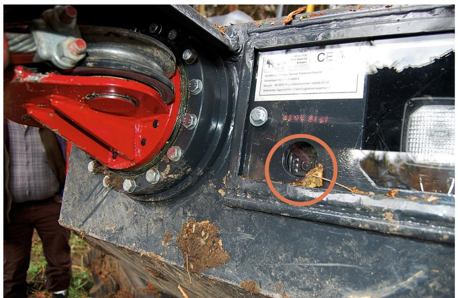
Eine Kamera (Kreis) zeigt dem Fahrer das Gelände, eine weitere innerhalb des Gehäuses filmt die Aufspulung des Seils auf die Winde.
