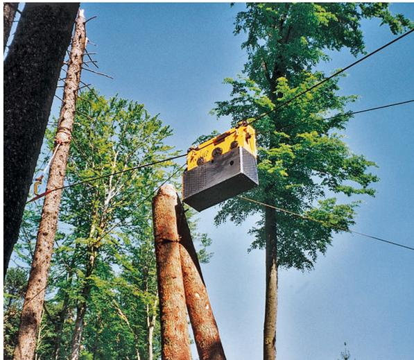
Seilbahn mit Selbstfahrlaufwagen. Die Funkfernsteuerung erfolgt über zwei Sender mit Übergabefunktion.
