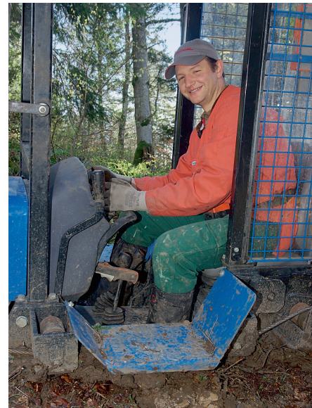
Martial Oppliger ist als Traktorführer für den Forstunternehmer Philippe Masi, Fleurier, tätig. Die verstärkten Trittbretter decken die Windenseile ab.
