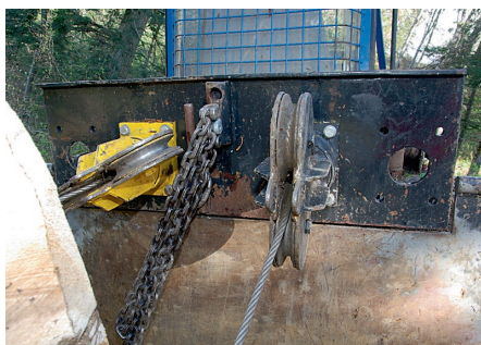
Um die Stabilität des Traktors zu verbessern wurde der Seileinlauf gegen die Mitte verschoben.
