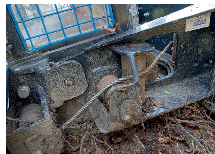
Die 13 mm starken Windenseile sind überall zugänglich und werden durch einfache Rollen geführt.
