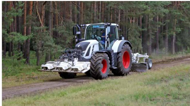
**Schlagkräftig:** Schlepper mit Plattenverdichter im Front- und Wegeinstandsetzungsgerät im Heckhubwerk.
