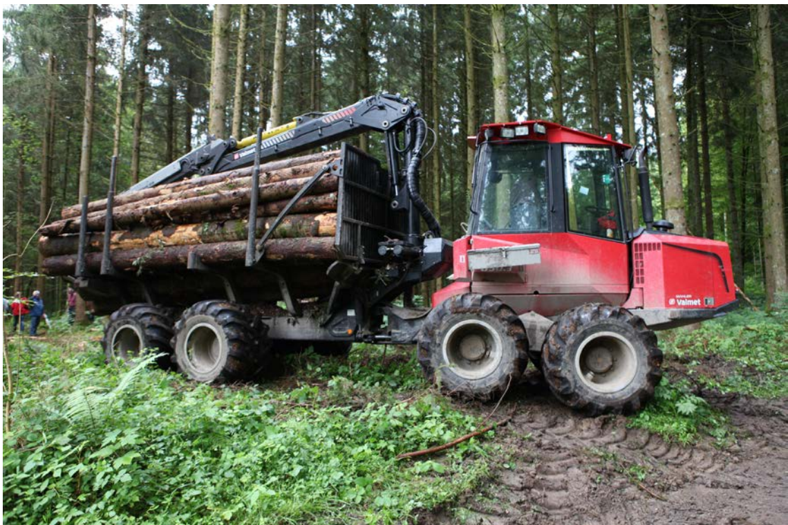
Abbildung 4 Der im Befahrungsversuch eingesetzte Forwarder Valmet 830.3, beladen mit halber Ladung.
