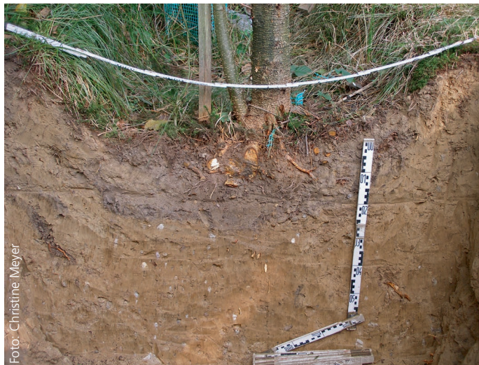
Abbildung 5: Bodenprofil durch eine Fahrspur ohne Kompost direkt an der Stammbasis verlaufend. Erkennbar ist die Durchwurzelung durch den verdichteten Bereich bis zu etwa 50 cm Tiefe.
