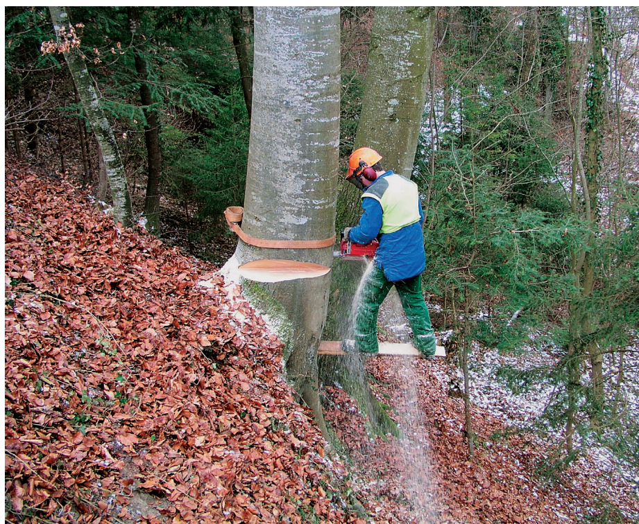
Eine typische Situation in welcher ein Sprungbrett die Fällarbeit sehr erleichtern kann.
