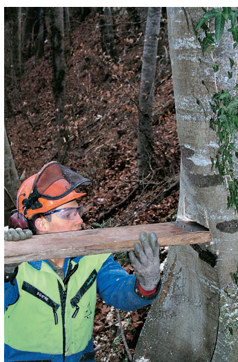
Das Loch, in welchem das Brett verankert wird, darf nicht in Faserrichtung des Bandes sein; sonst kann das Band beim Fällen ausreissen.
