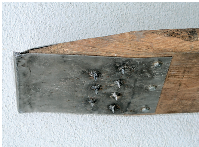
Ein Standbrett mit metallverstärkter Spitze. Die Kante oben wird unter Last ins Holz gepresst, die unterseitig angeschweissten Dornen verhindern ein seitliches Wegrutschen.
