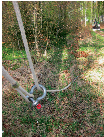
Schritt 3: Mit dem Einziehen des Windenseiles schliesst sich die Seilschlinge.
