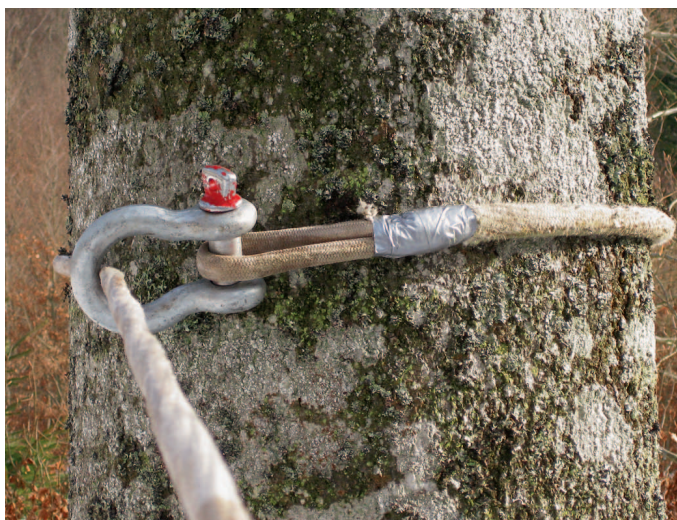
Schritt 2: Mit der Anschlagkralle wird das Seil entgegen der Fällrichtung in der gewünschten Höhe fixiert.
