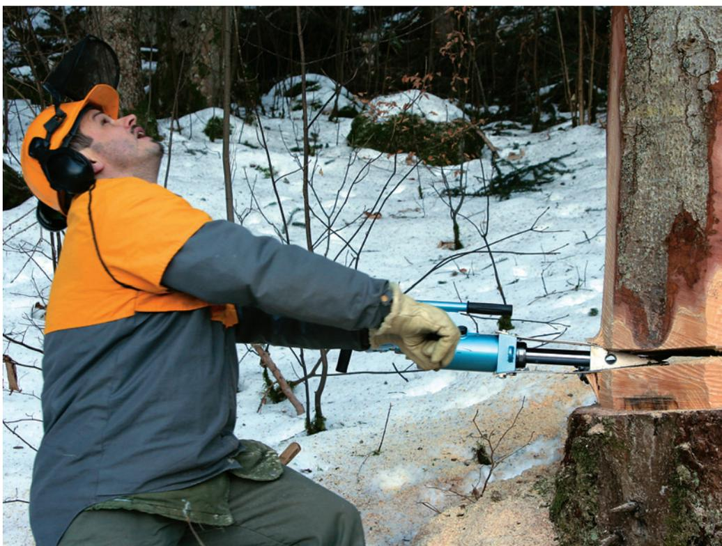
Abbildung 3: Die hydraulischen Fällhilfen erleichtern das Keilen und machen diese Arbeit sicherer. Den Seilzug ersetzen sie jedoch nicht.
