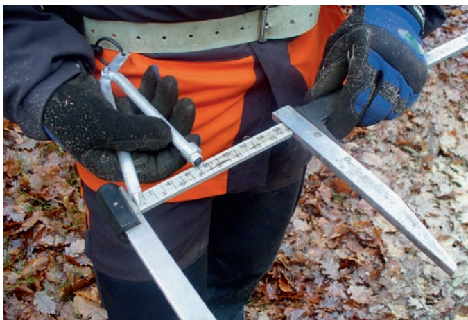
Einstellen des Fällzirkels, nachdem der Durchmesser der Stammwalze per Messkluppe ermittelt wurde. Empfohlen sind 15% des Durchmessers plus 1 cm als Sicherheitsmass.
