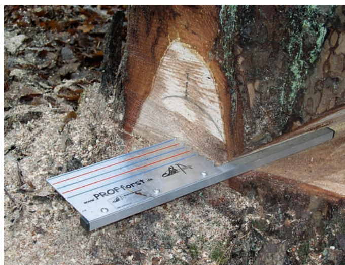
Zirkel in die Fallkerbgrundlinie einlegen und einen Bogen schlagen. Am höchsten Punkt des Bogens wird anschliessend ein senkrechter Strich eingezeichnet. Die Schnittstelle bezeichnet den Punkt, bis zu welchem der Fällschnitt zu führen ist.
