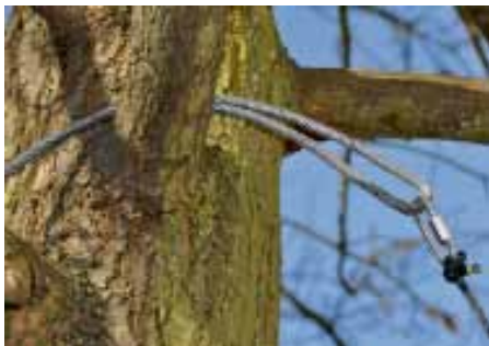
Das Windenseil wird mit der Nachziehleine über den Ast gezogen.
