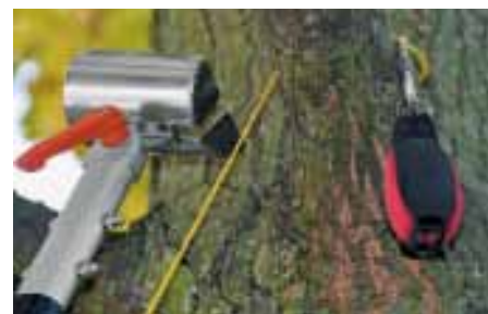
Der «DST-Lifter» befördert den Wurfbeutel über den Ast.
