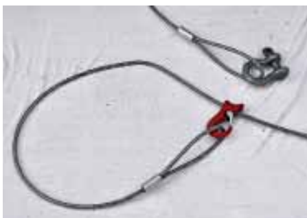
Das Verlängerungsseil aus Stahl mit Gleithaken (unten) wird durch einen Schäkkel mit dem Windenseil (oben) verbunden.
