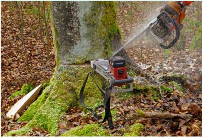
**Abb. 3:** Mit fernbedienbaren mechanischen Fällkeilen können Bäume erschütterungsarm aus der Distanz heraus zu Fall gebracht werden.
